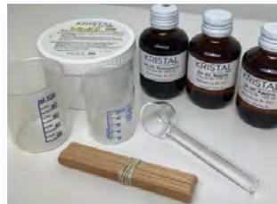
Résine Polyuréthane en 3 composants utilisée pour créer des répliques rigides. Ce produit n'adhère pas aux Plastiforms.
