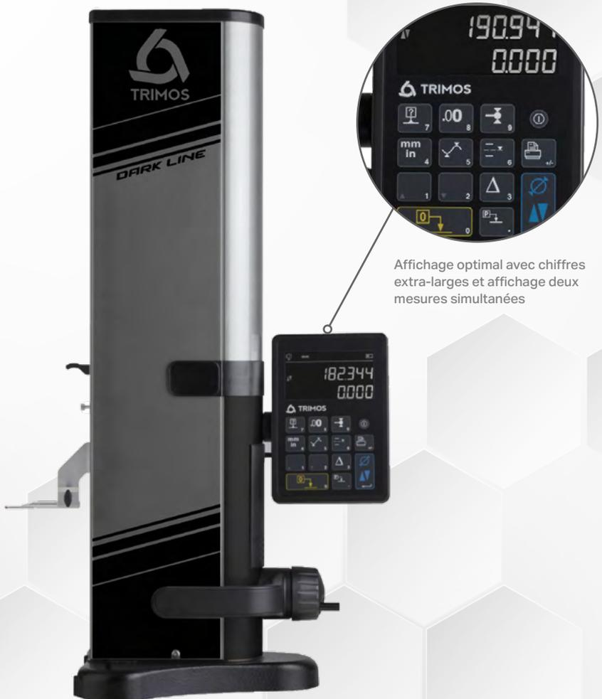
Affichage optimal avec chiffres extra-larges et affichage deux mesures simultanées
