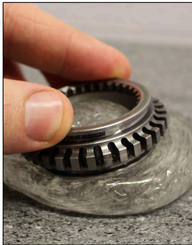
RE-FORM souple après chauffage accueillant une pièce à maintenir.
