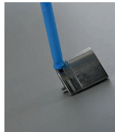
**Contrôle de rugosité d'une rainure au rugosimètre.**
