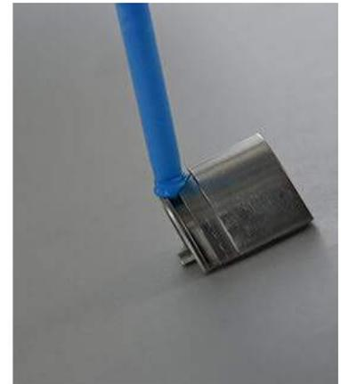
**Contrôle de rugosité d'une rainure au rugosimètre.**
