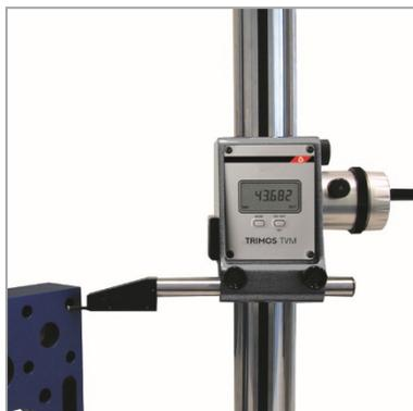
Mesure de diamètre avec touche bidirectionnelle (TVM4)
