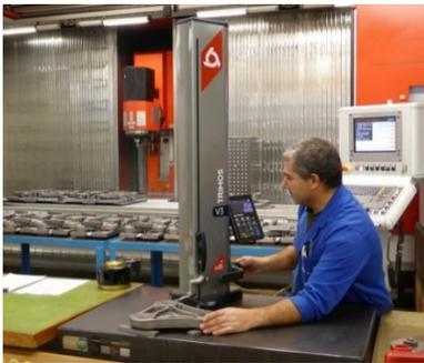
Avec une poignée de déplacement actionnée par la main gauche et une manivelle de mesure actionnée par la main droite, la position de l'utilisateur est à tout moment optimale par rapport à la pièce mesurée quelle que soit sa taille et sa forme. L'utilisateur garde le contrôle de l'instrument et le mouvement de la pièce à tout moment. L'orientation de l'écran assure une lisibilité parfaite dans toutes les configurations.
