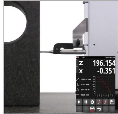
Mesure de perpendicularité avec palpeur électronique (TA-IH-126, TA-MS-101)
