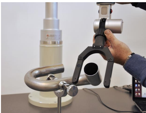
Système de mesure de tubes avec fourche laser
