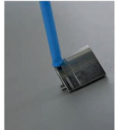
**Contrôle de rugosité d'une rainure au rugosimètre.**
