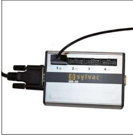
Instruments digimatiques connectés à un module MB-4D
