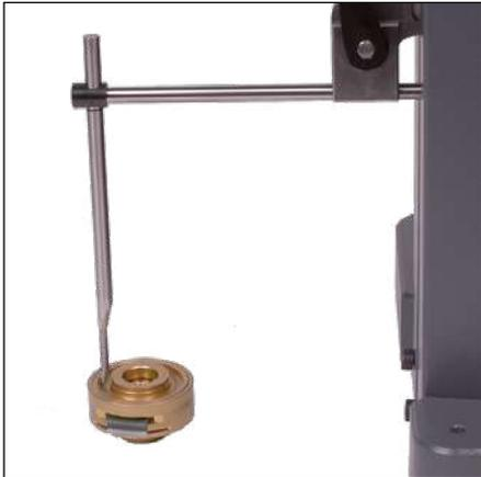
Mesure de profondeur avec accessoires 930.2108 et 930.2105
