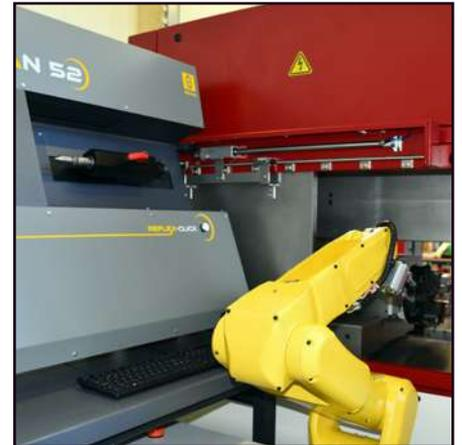
SCAN 52 et robot : boucle fermée avec correction automatique de la pièce
