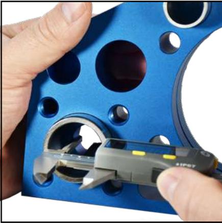
Mesure profonde avec S\_Cal EVO Smart DM
