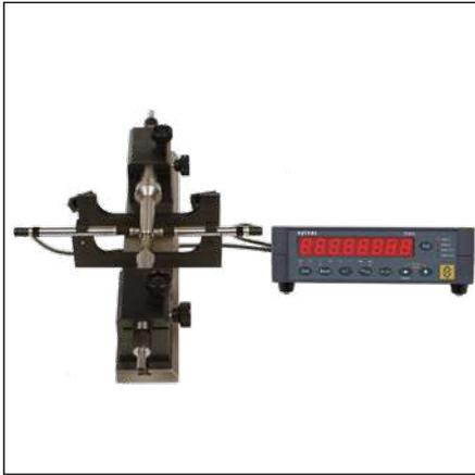
Mesure d'un axe avec 2 palpeurs (A+B)
