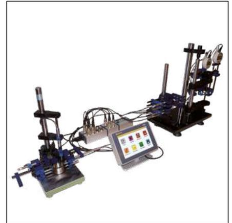
Palpeurs et comparateurs connectés via des modules M-BUS sur une D400S
