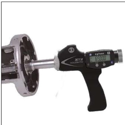
Mesure avec système XT3H à pistolet
