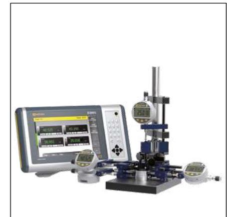
Connexion de comparateurs avec technologie sans fil Bluetooth® sur D300S.
