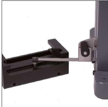
Mesure de profondeur avec accessoires 930.2108 et 905.2204
