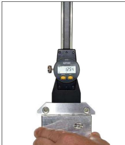
Mesure d'une profondeur
