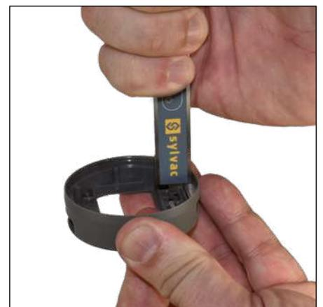
Mesure de profondeur avec S\_Cal EVO
