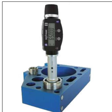
Mesure avec système XT3D à rochet
