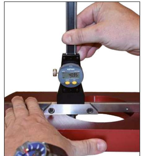
Mesure de profondeur dans un grand alésage grâce aux ponts additionnels
