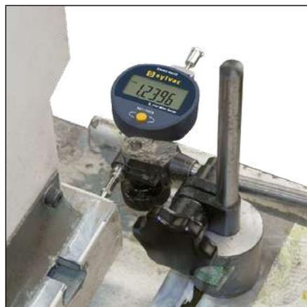
Mesure du déplacement vertical d'un élément
