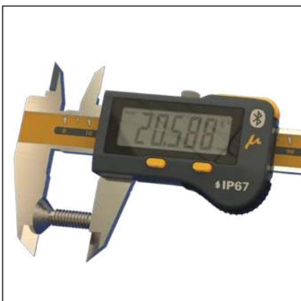
Mesure d'une pièce avec S\_Cal  $\mu\text{m}$
