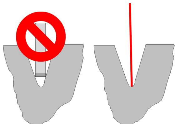
La faisceau CCMP permet d'aller rechercher les points de rebroussement dans des zones extrêmement réduites et non accessible à un capteur par contact.
