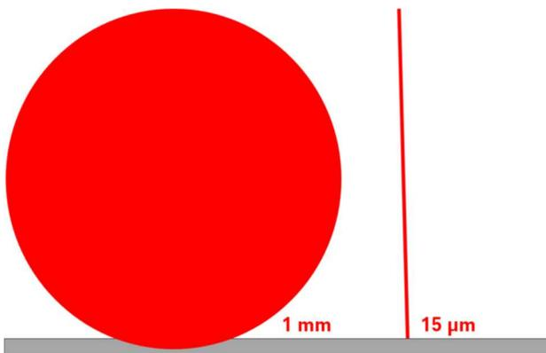
Le faisceau du capteur CCMP est extrêmement petit comparé à une bille de 1 mm. De plus il n'y a pas d'influence due à la déformation de matière lors de la mesure.
