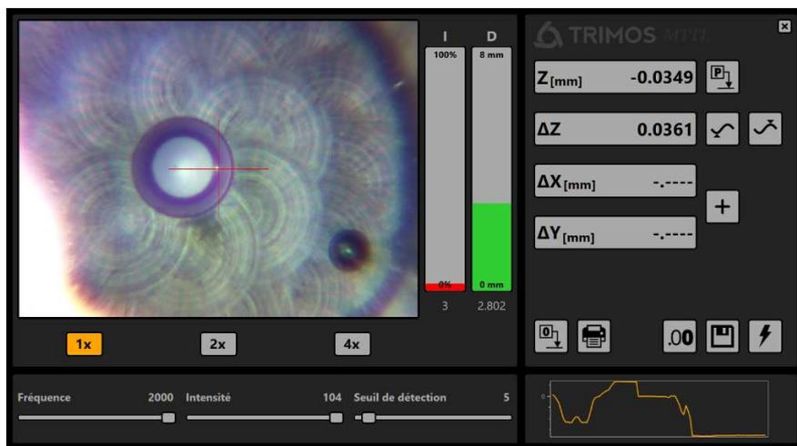
Le logiciel **Trimos Compact Z** est extrêmement simple. Sa philosophie s'inspire de celle des colonnes de mesures qui ont fait le succès de Trimos. Il permet des mesures rapides de hauteurs sans contact même pour des utilisateurs sans expérience.
