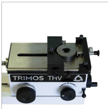
Etalonnage de bagues lisses (THV-260)
