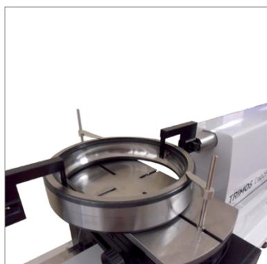
Mesure intérieure automatique d'une bague de roulement à bille
