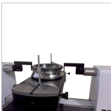
Mesure extérieure automatique d'une bague de roulement à bille
