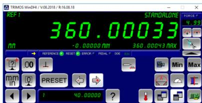
Le logiciel de mesure WinDHI est développé par Trimos et utilisé exclusivement sur ses instruments. Cette solution facilite grandement la réalisation de toutes les mesures en guidant l'utilisateur pas à pas.
