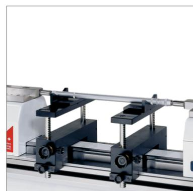
Etalonnage de micromètres
