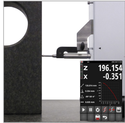
Mesure de perpendicularité avec palpeur électronique (TA-IH-126, TA-MS-101)
