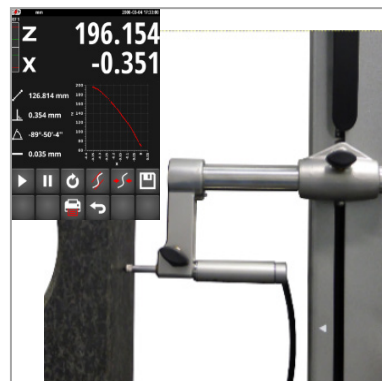
Mesure de la perpendicularité avec palpeur électronique (TA-IH-136, TA-MS-101)
