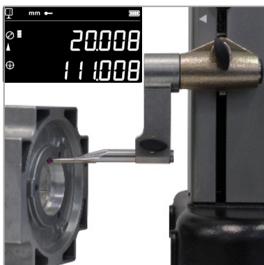
Affichage simultané du diamètre et entraxe (TA-IH-135, TA-MI-101)
