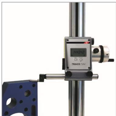
Mesure de hauteurs et de profondeurs (TVM1/1.1/2)
