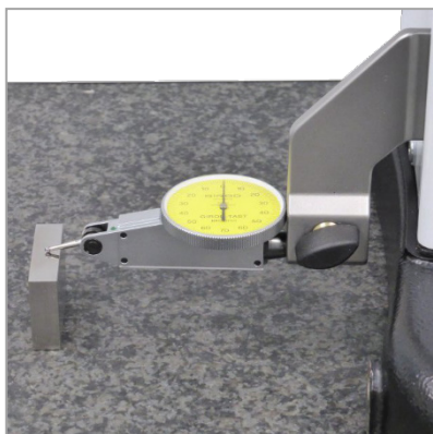
Réglage fin pour les applications nécessitant un positionnement très précis de la touche.
