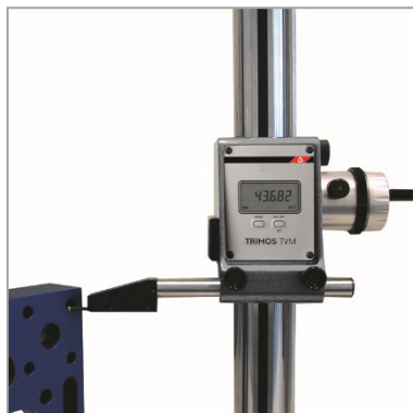
Mesure de diamètre avec touche bidirectionnelle (TVM4)
