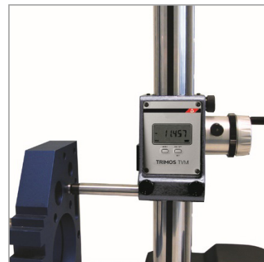
Mesure d'entraxes avec cônes (TVM5)
